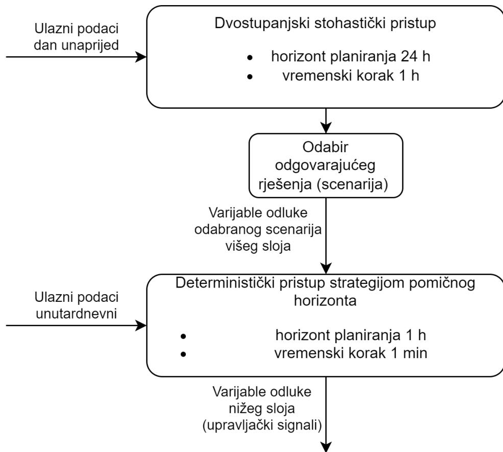
**Slika 4.2:** Predloženi pristup za razvoj unaprijedenog modela dvoslojnog adaptivnog sustava za kratkoročno upravljanje energijom unutar energetske zajednice
