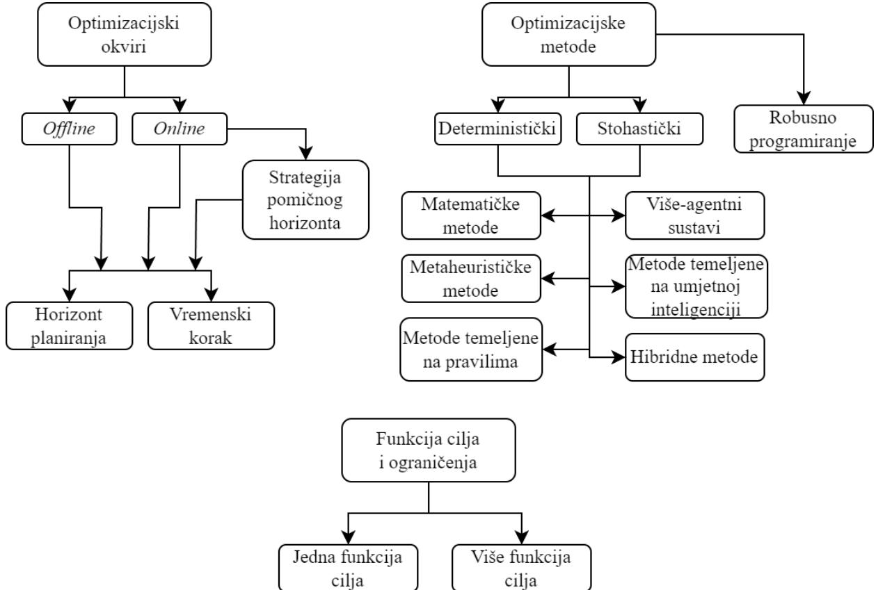
**Slika 2.2:** Glavni elementi optimizacijskog modela sustava upravljanja energijom unutar energetske zajednice
