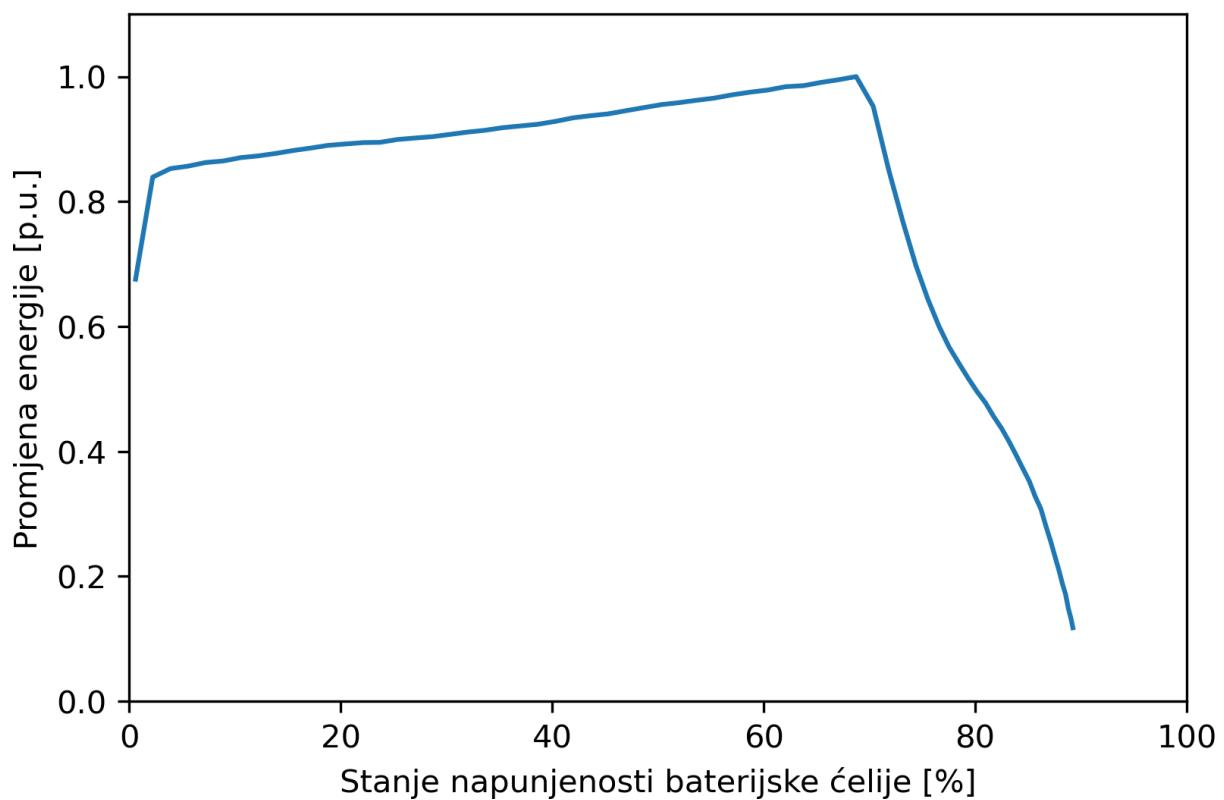
Slika 7.5: Karakteristika  $\Delta SOE^{ch}/SOE$  baterijske čelije LG 18650HG2 kapaciteta 3000 mAh
