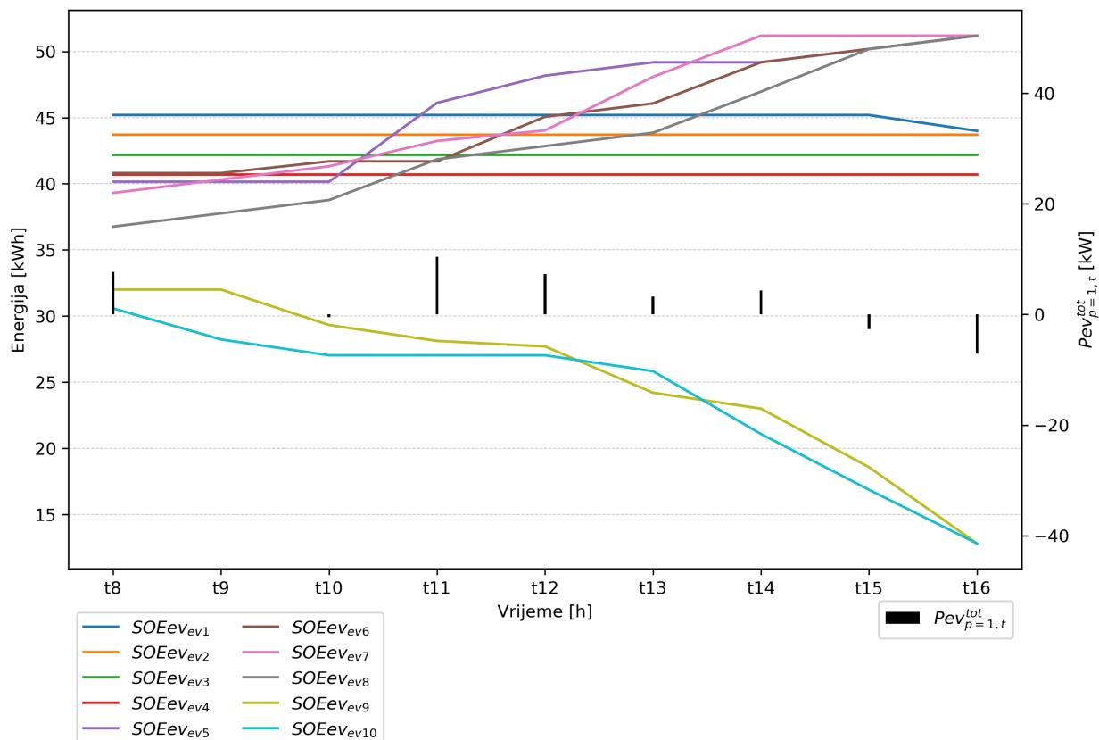
Slika 7.25: Stanja napunjenosti i ukupne angažirane snage punjenja i pražnjenja baterija električnih vozila kod 1. aktivnog kupca u 1. skenariju
