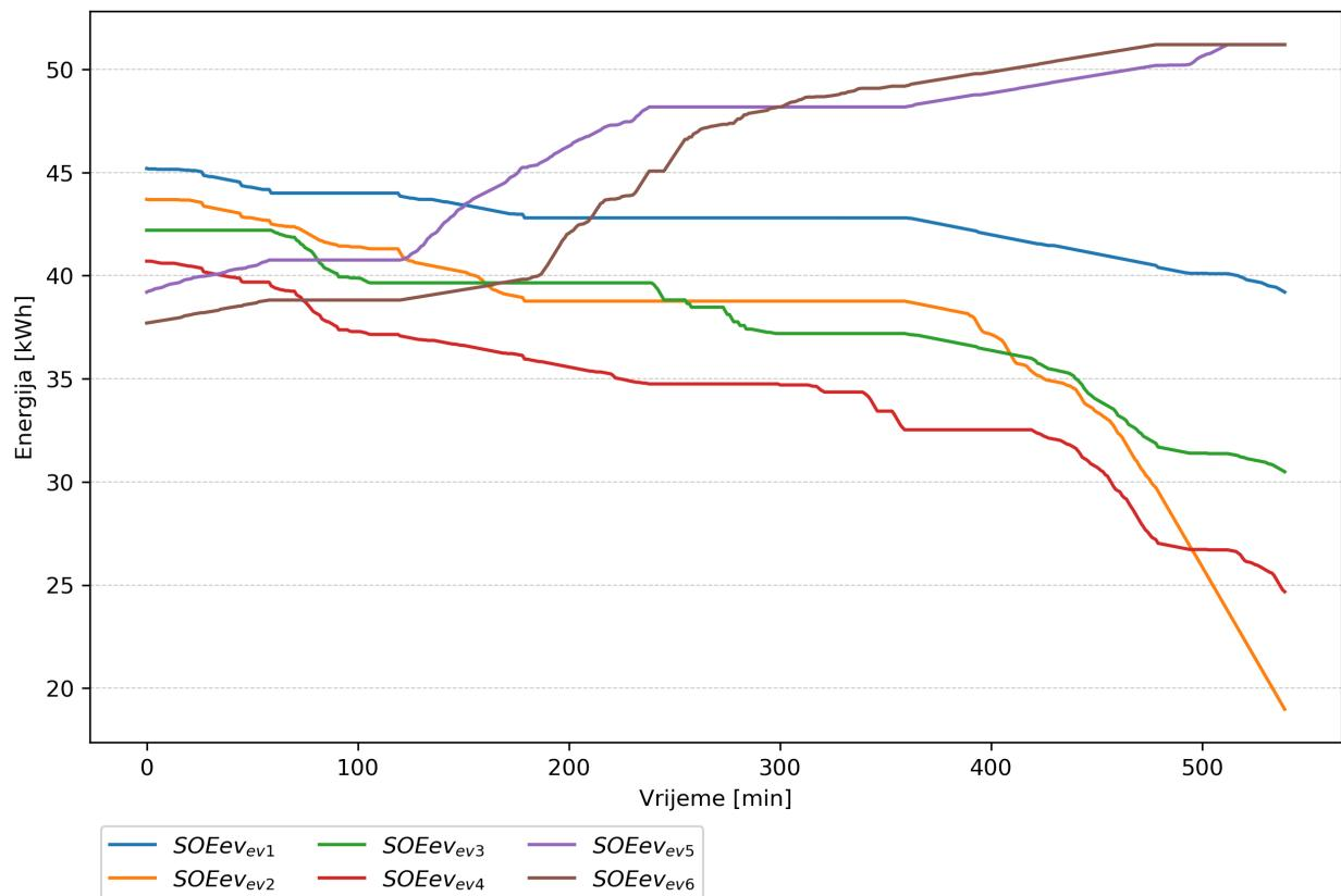
Slika 7.42: Stanja napunjenošću baterija električnih vozila kod 2. aktivnog kupca za slučaj sa 6 električnih vozila priključenih na punionice
