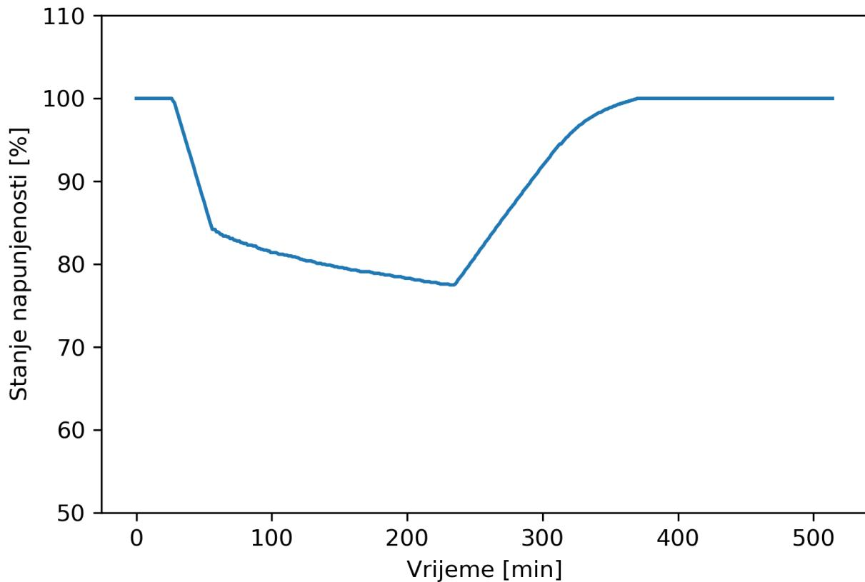
Slika 7.4: Promjena stanja napunjenoosti olovne gel (Pb GEL) baterije kapaciteta 110 Ah
