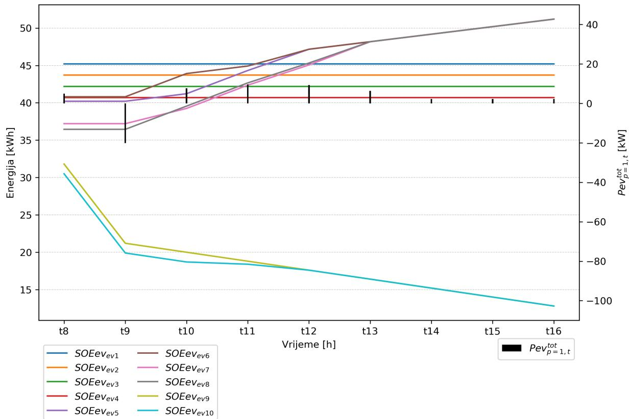
Slika 7.31: Stanja napunjenošću i ukupne angažirane snage punjenja i pražnjenja baterija električnih vozila kod 1. aktivnog kupca ne uzimajući u obzir virtualne troškove degradacije baterije električnog vozila
