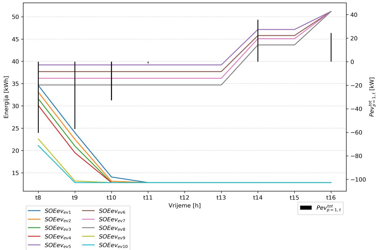
**Slika 7.32:** Stanja napunjenosti i ukupne angažirane snage punjenja i pražnjenja baterija električnih vozila kod 1. aktivnog kupca uzimajući u obzir virtualne troškove degradacije baterije električnog vozila
