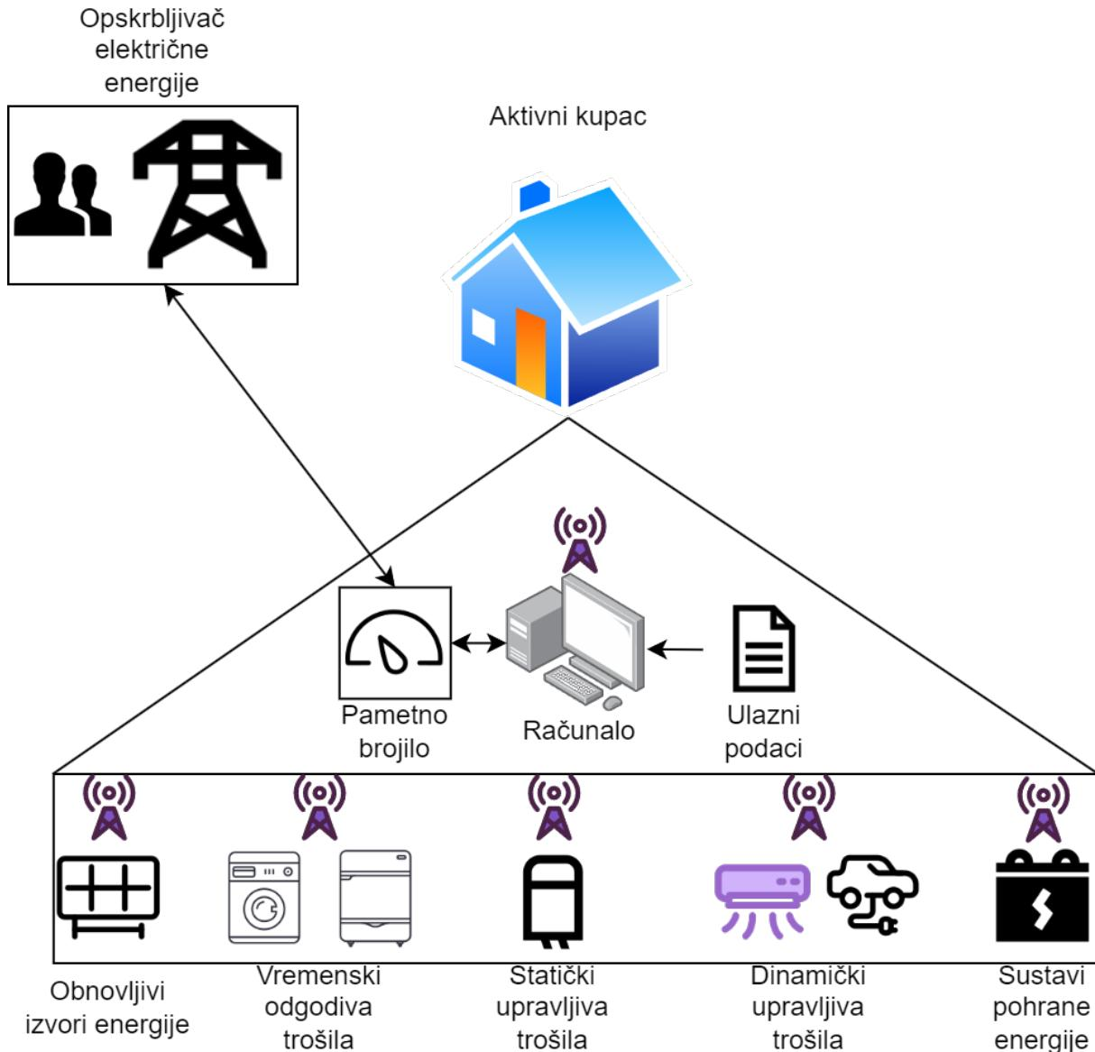
**Slika 2.1:** Primjer sustava upravljanja energijom aktivnog kupca
