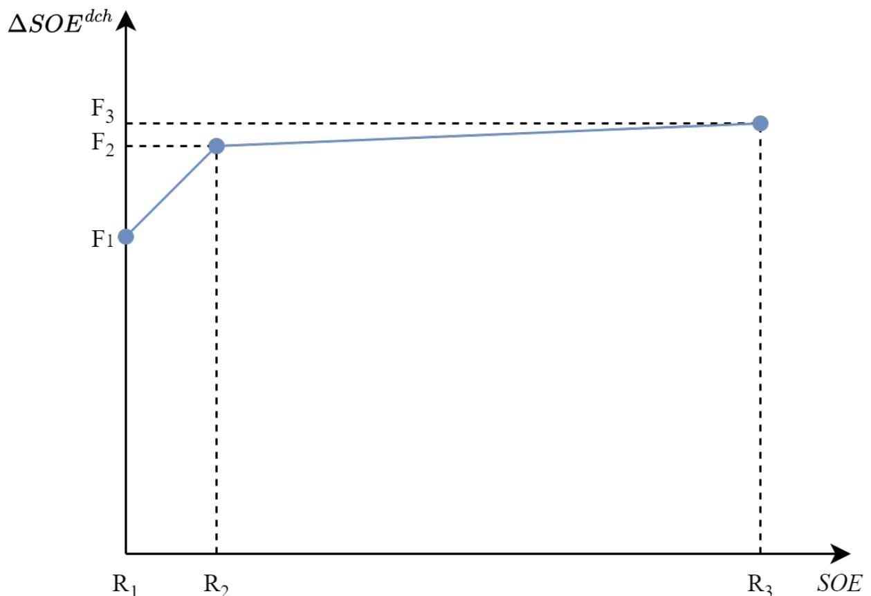
Slika 5.7: Karakteristika  $\Delta SOE^{dch}/SOE$  energetskog modela pražnjenja baterije
