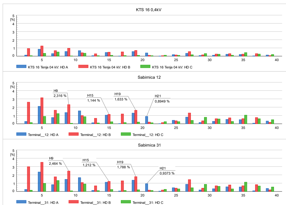
Slika 5.22. Stanje ispitne mreže u 17:00 h u karakterističnim sabirnicama nakon optimizacije
