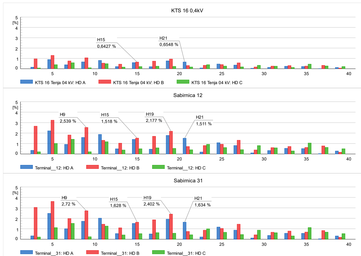
Slika 5.20. Stanje ispitne mreže u 17:00 h na karakterističnim sabirnicama prije pokretanja postupka optimizacije
