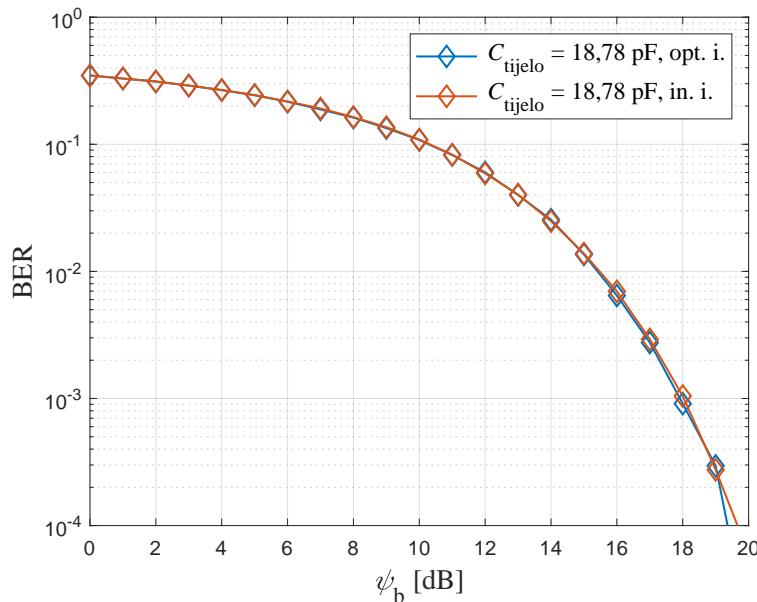
Slika 4.9: Učestalost pogreške prilikom detekcije bita (BER) kod ISK-CC-HBC uz  $C_{tijelo} = 18,78 \text{ pF}$
