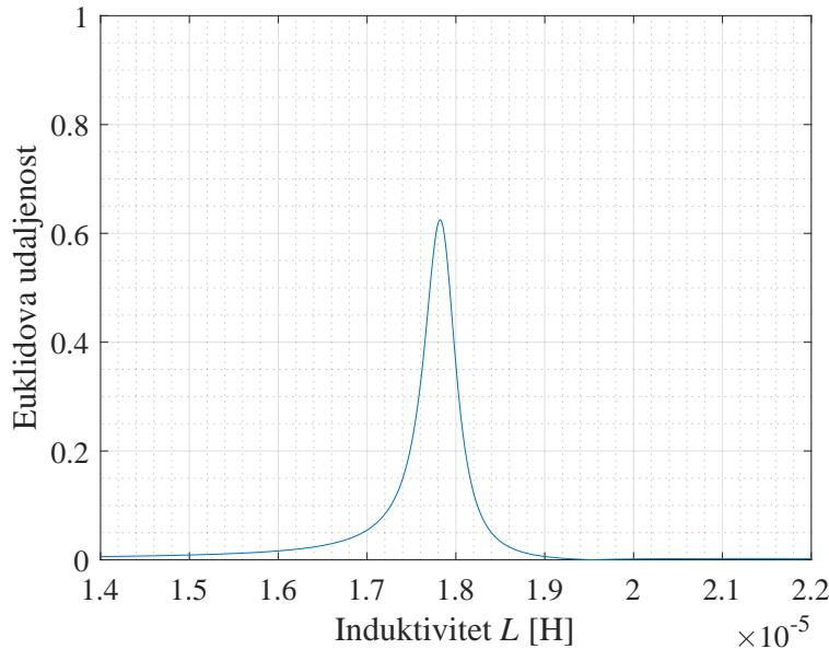
Slika 4.2: Ovisnost Euklidove udaljenosti o induktivitetu  $L$
