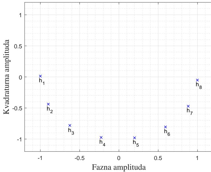
**Slika 3.5:** IIM-CC-HBC konstelacijski dijagram s inicijalnim parametrima
