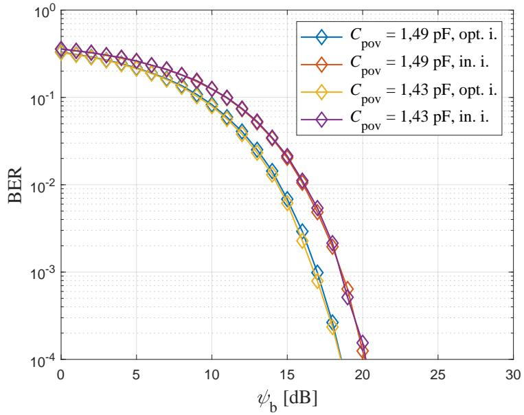
**Slika 4.19:** Učestalost pogreške prilikom detekcije bita (BER) kod ISK-CC-HBC uz  $C_{\text{pov}} = 1,49 \text{ pF}$  i  $C_{\text{pov}} = 1,43 \text{ pF}$
