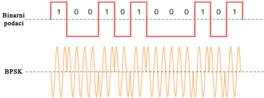
Slika 2.14: *BPSK modulacijski postupak* [33]
