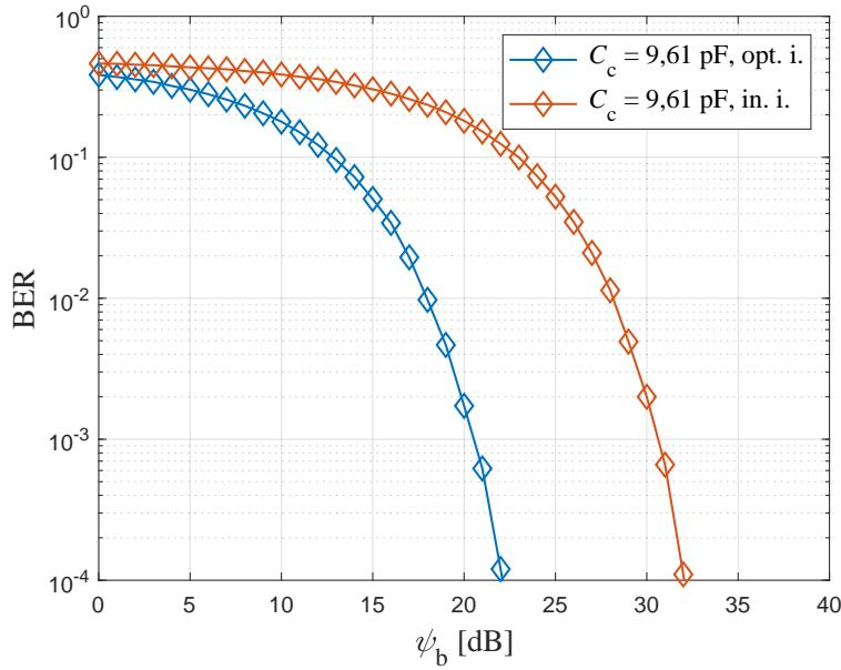
Slika 4.10: Učestalost pogreške prilikom detekcije bita (BER) kod ISK-CC-HBC uz  $C_c = 9,61 \text{ pF}$
