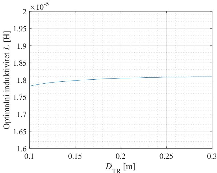
Slika 4.5: Ovisnost optimalnog induktiviteta  $L$  o udaljenosti  $D_{\text{TR}}$
