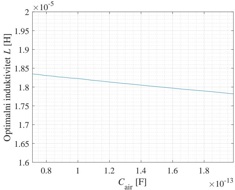
Slika 4.11: Ovisnost optimalnog induktiviteta  $L$  o kapacitetu  $C_{\text{zrak}}$
