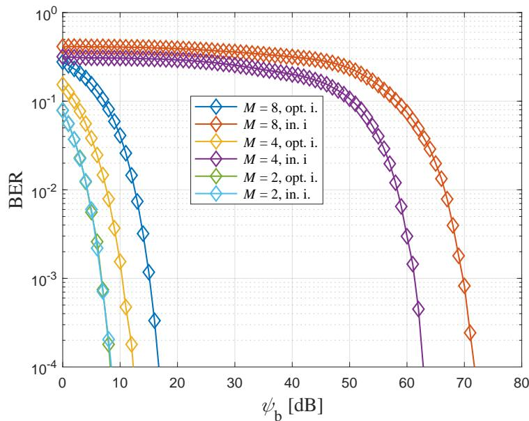
Slika 3.19: Učestalost pogreške prilikom detekcije bita (BER) za veličinu elektroda  $2 \times 2$  cm
