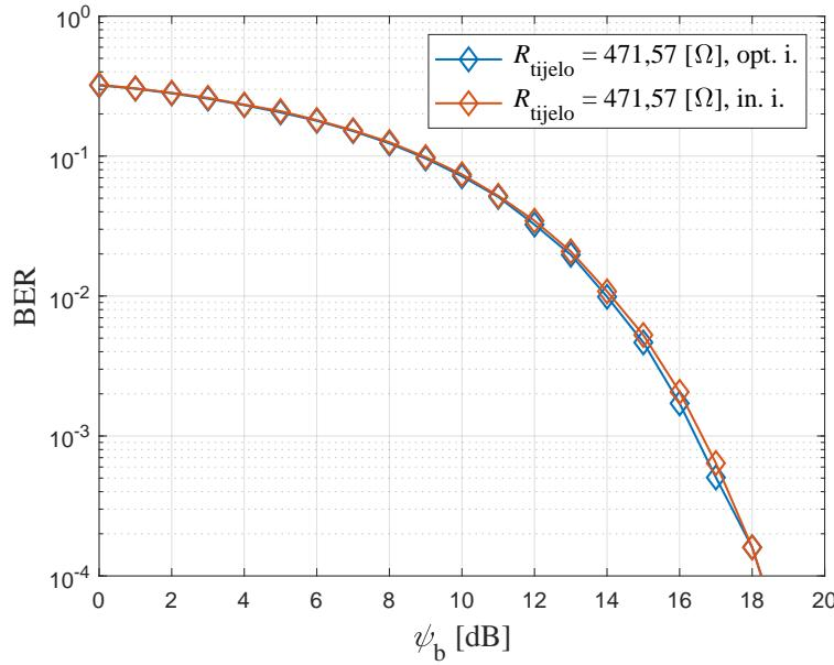
Slika 4.8: Učestalost pogreške prilikom detekcije bita (BER) kod ISK-CC-HBC uz  $R_{tijelo} = 471,57 \Omega$
