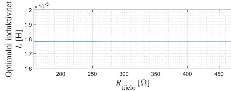
(b) Ovisnost optimalnog induktiviteta  $L$  o parametru  $R_{\text{tijelo}}$
