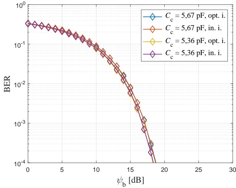
Slika 4.20: Učestalost pogreške prilikom detekcije bita (BER) kod ISK-CC-HBC uz  $C_c = 5,67 \text{ pF}$  i  $C_c = 5,36 \text{ pF}$
