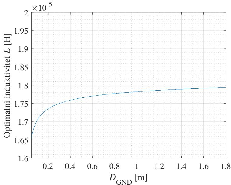
Slika 4.17: Ovisnost optimalnog induktiviteta  $L$  o udaljenosti  $D_{GND}$
