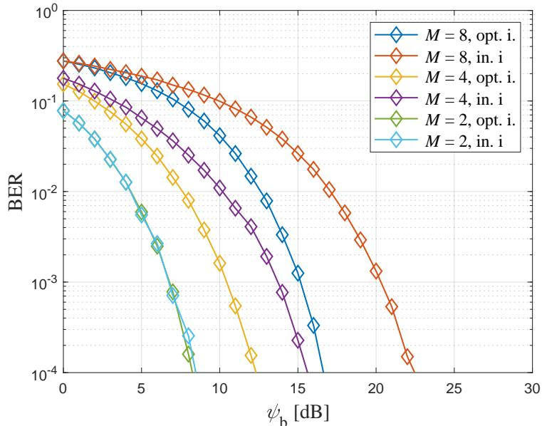
Slika 3.18: Učestalost pogreške prilikom detekcije bita (BER) pri  $D_{\text{GND}} = 1,8 \text{ [m]}$
