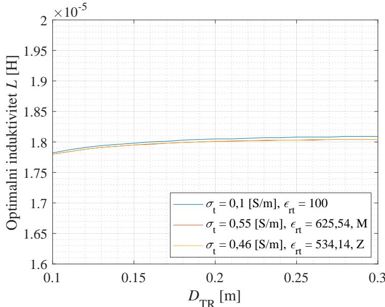
**Slika 4.13:** Ovisnost optimalnog induktiviteta  $L$  o udaljenosti  $D_{\text{TR}}$
