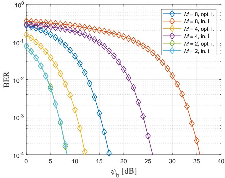
Slika 3.7: Učestalost pogreške prilikom detekcije bita (BER) pri  $D_{\text{TR}} = 0,2$  m
