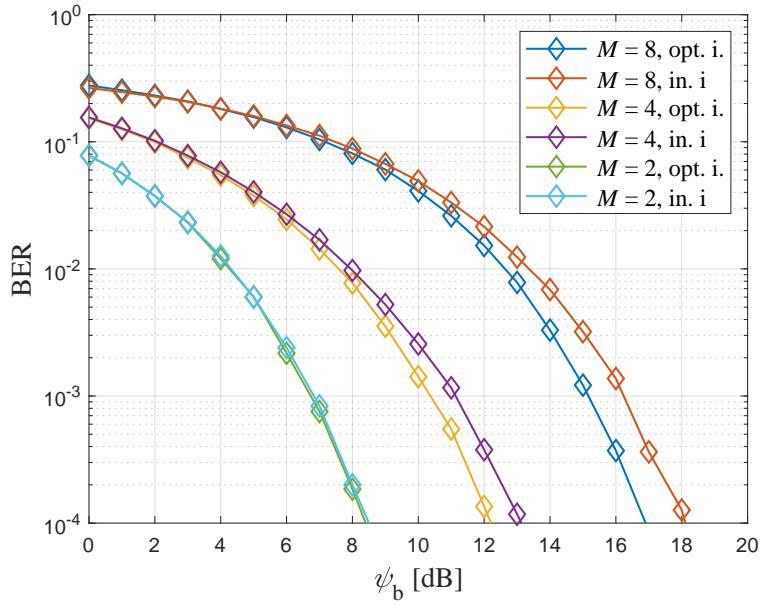
Slika 3.17: Učestalost pogreške prilikom detekcije bita (BER) pri  $D_{\text{GND}} = 1,2 \text{ [m]}$
