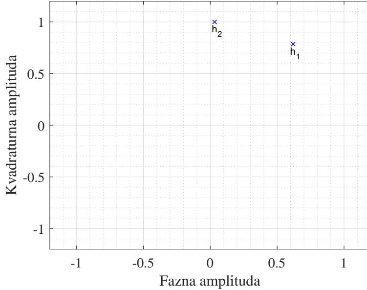
Slika 4.3: ISK-CC-HBC konstelacijski dijagram s inicijalnim parametrima
