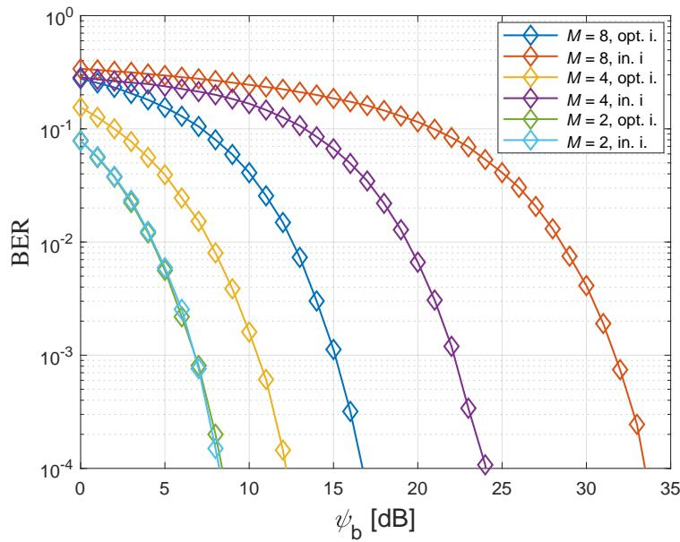
Slika 3.12: Učestalost pogreške prilikom detekcije bita (BER) kod IIM-CC-HBC uz  $C_{\text{zrak}} = 71,15 \text{ fF}$
