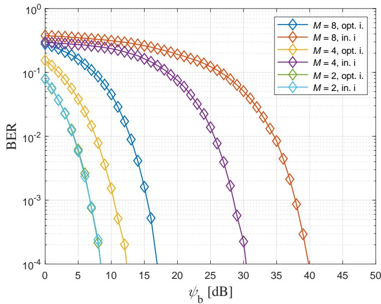
Slika 3.8: Učestalost pogreške prilikom detekcije bita (BER) pri  $D_{\text{TR}} = 0,3 \text{ [m]}$
