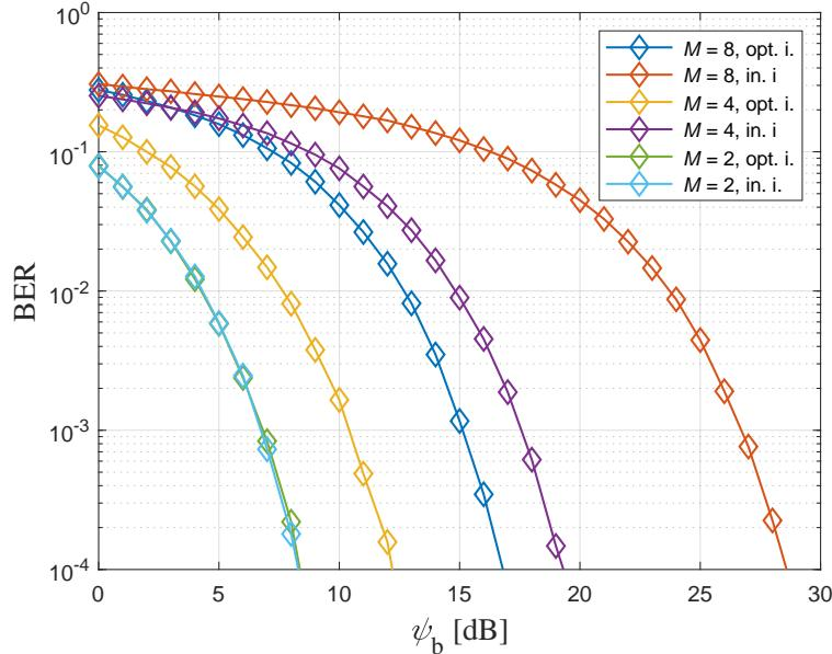
**Slika 3.11:** Učestalost pogreške prilikom detekcije bita (BER) kod IIM-CC-HBC uz  $C_c = 9,61 \text{ pF}$  i fiksiranu vrijednost parametra  $D_{\text{GND}}$
