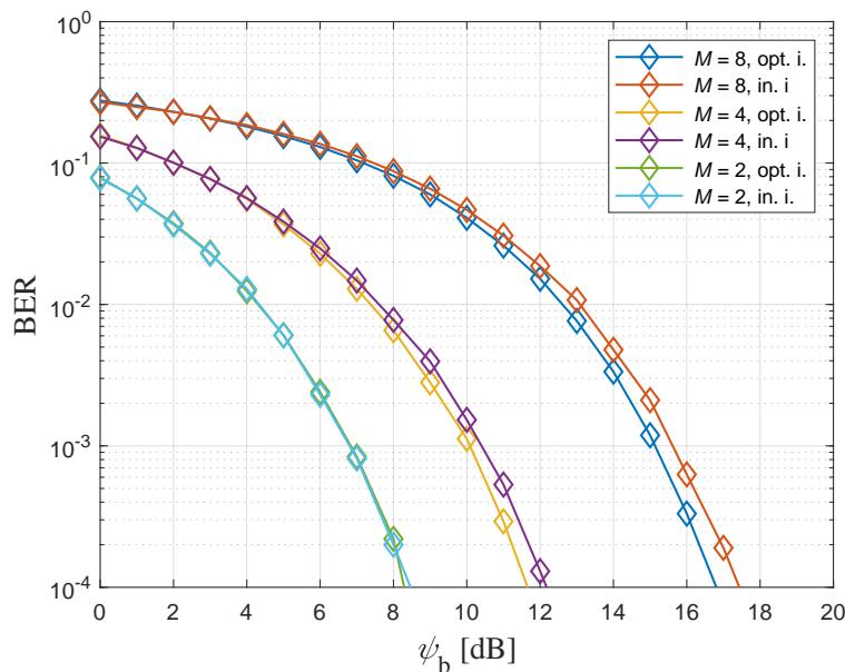
Slika 3.10: Učestalost pogreške prilikom detekcije bita (BER) kod IIM-CC-HBC uz  $C_{tijelo} = 18,78 \text{ pF}$
