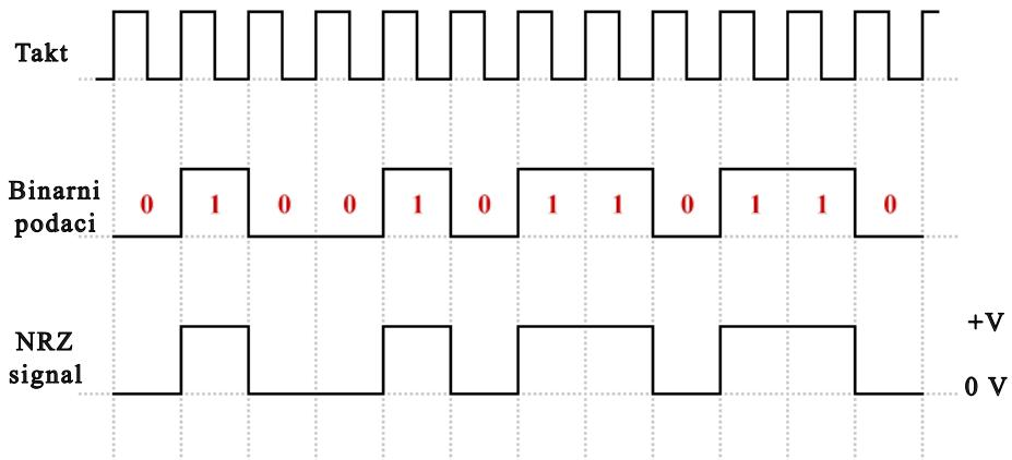
Slika 2.16: NRZ linijsko kodiranje [50]
