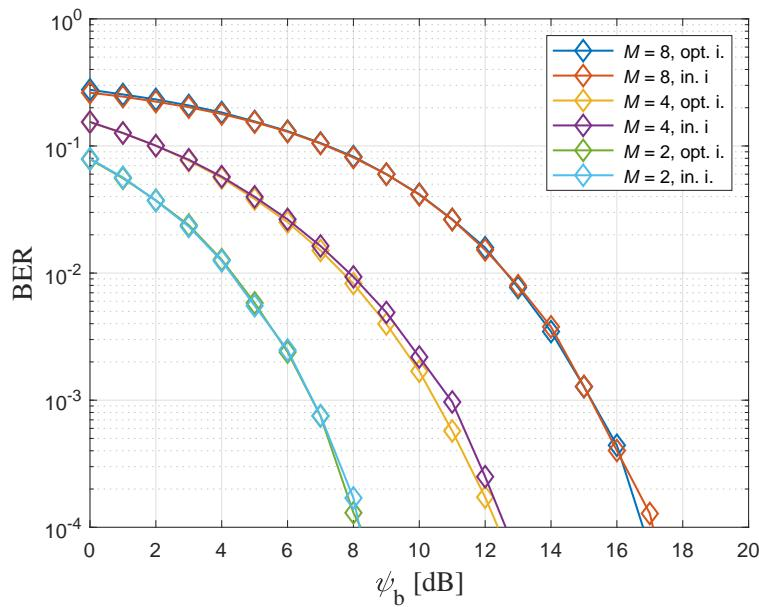
Slika 3.9: Učestalost pogreške prilikom detekcije bita (BER) kod IIM-CC-HBC uz  $R_{tijelo} = 471,57 \Omega$
